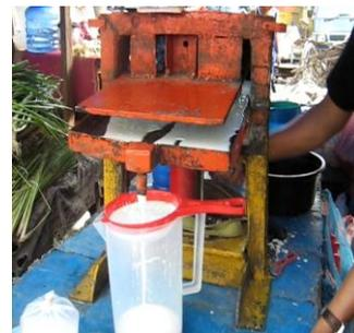
**Gambar 1. Alat Pemeras Kelapa Parut Aktual**
