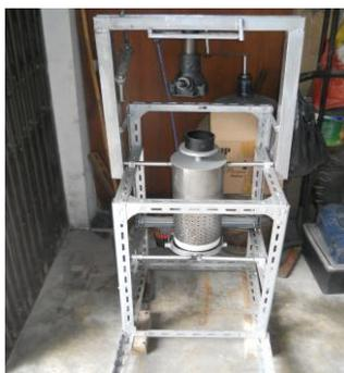
**Gambar 5. Rancangan Alat Pemeras Kelapa Parut Usulan**
